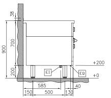
Electrical inlet (power) EQ **Equipotential screw**
